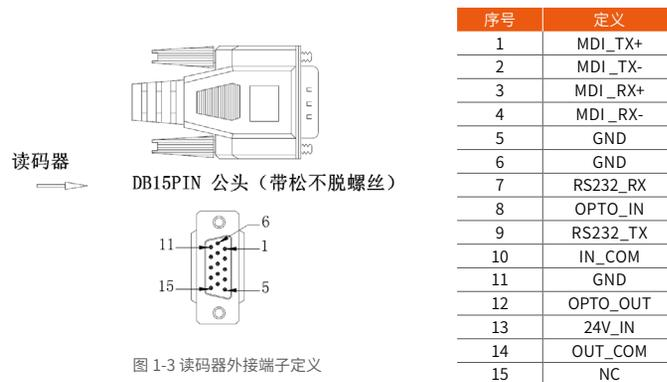
图 1-3 读码器外接端子定义
